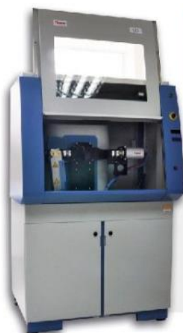
Дифрактометр ARL X'TRA, образец дифрактограммы и заключения.
