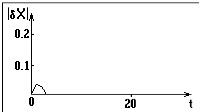
Рис. 1.11: График нормы текущего отклонения \delta X(t) при \delta X_0 = 10^{-2} \cdot (1, 1, 1)^T , p_0 = 0 , p_1 = 1
