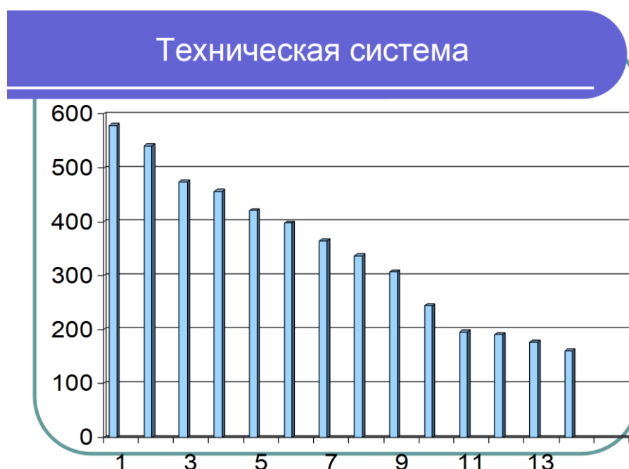
Рисунок 1. Соотношение типов трудных ситуаций группы «Техническая система»: 1 – проезд запрещающего сигнала – 579 р.; 2 – обрыв автосцепки – 541 р.; 3 – плохая управляемость автотормозами – 474 р.; 4 – внезапное перекрытие сигнала – 457 р.; 5 – неисправность и/или рассогласованная работа контроля безопасности движения локомотива – 421 р.; 6 – утечка воздуха в тормозной сети поезда – 398 р.; 7 – устранение неисправности локомотива или в поезде на перегоне – 365 р.; 8 – большое количество предупреждений снижения скорости движения по перегону – 337 р.; 9 – проведение длинносоставного тяжеловесного поезда (4500–6000 т) на затяжном спуске или подъеме и по многообразным кривым малого радиуса – 307 р.; 10 – выполнение технической скорости – 245 р.; 11 – проследование нейтральной вставки с тяжеловесным длинносоставным поездом (от 4500 до 6000 тонн) после трогания перед нейтральной вставкой – 196 р.; 12 – экономия электроэнергии – 191 р.; 13 – буксование одной колесной пары – 177 р.; 14 – наблюдение за подвижным составом встречного локомотива – 161 р.
