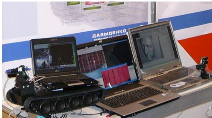
**Рис. 3.** Макет программно-аппаратного комплекса изучения компьютерного зрения
